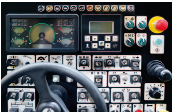
Операторский пульт управления с одиночными переключателями
