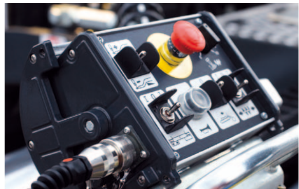
Боковой пульт управления плитой
