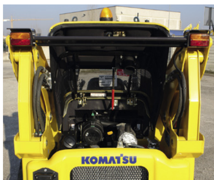
Капот: быстрая проверка двигателя
