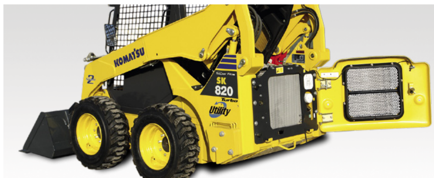
Задняя дверь: удобная проверка и очистка радиаторов
