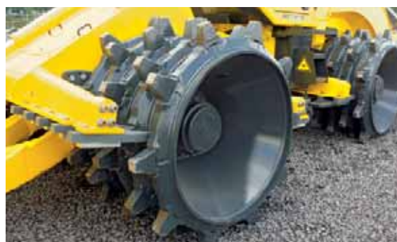
Сварной диск колеса с внутренними конусами с двух сторон для обеспечения оптимальной устойчивости.
