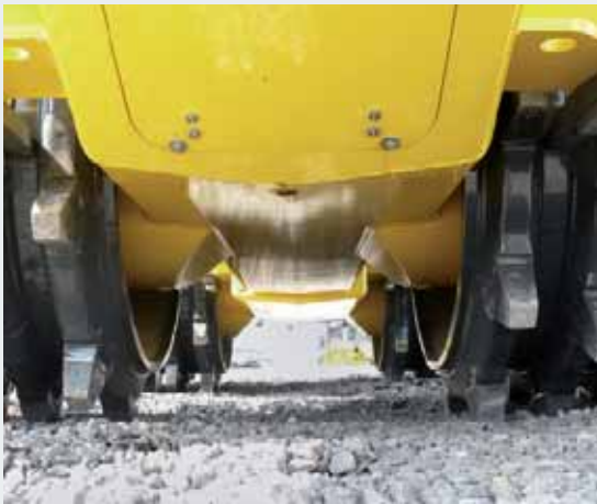
Максимальная защита всех агрегатов, никаких проникновений инородных предметов, т.е. никакого воспламенения на горячих деталях.
