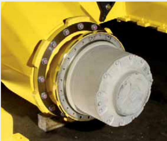
Две независимые друг от друга тормозные системы (гидростатическая в качестве рабочего тормоза и многодисковая в качестве стояночного тормоза).
