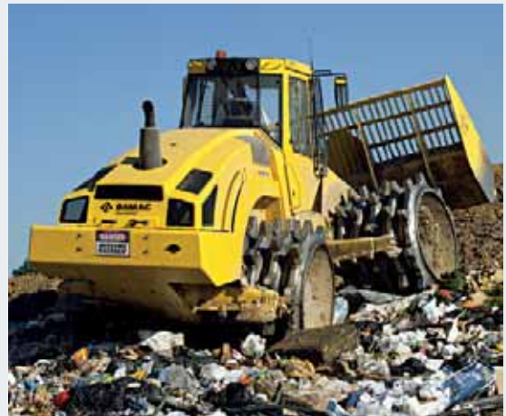
Оптимальное уплотнение благодаря качающему шарнирному сочленению, что обеспечивает оптимальное распределение нагрузки на уплотнительные колеса.
