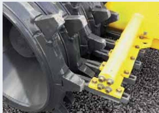
Saubere Räder durch Abstreifer (optimale Verdichtung).
