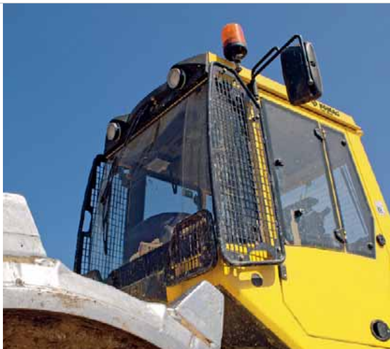
Комфортабельная кабина в соответствии со стандартом ROPS и FOPS.
