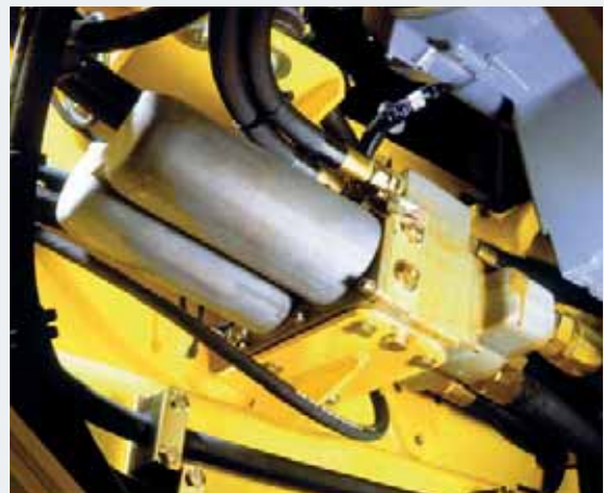
Система фильтрации с электронным контролем для минимизации затрат на обслуживание.
