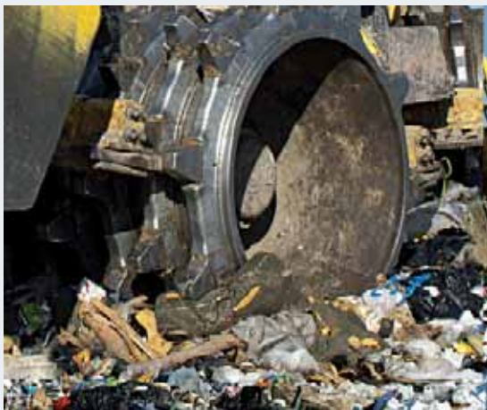
Скребки обеспечивают чистоту колес и гарантируют оптимальное уплотнение.
