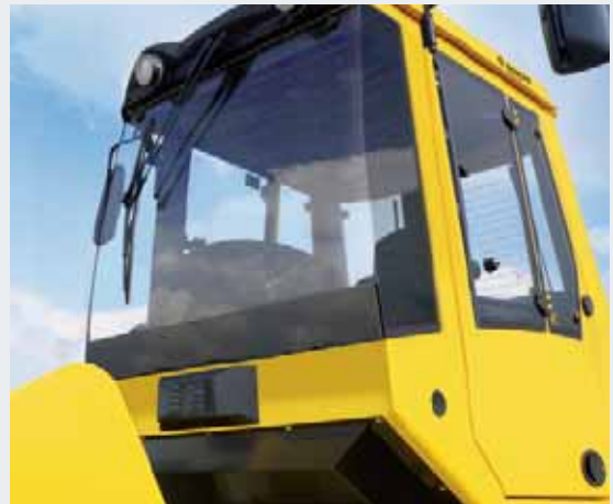
Конструктивное исполнение кабины в соответствии с требованиями ROPS и FOPS.
