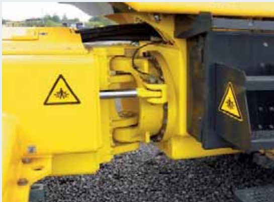
Оптимальное тяговое усилие благодаря поворотнo-качающемуся шарнирному сочленению (равномерный, непрерывный контакт колес с грунтом).
