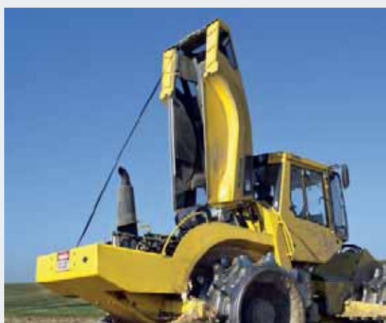
Удобное расположение и большой размер отверстий и проемов для проведения технического обслуживания и для обеспечения простого доступа ко всем элементам привода.
