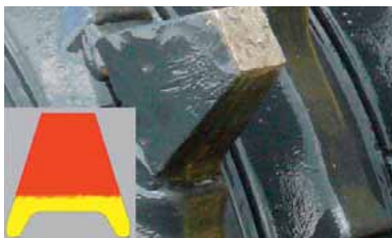
Зубья повышенной износостойкости гарантией на износ на 10000 часов работы.
