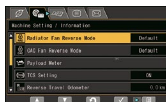
Индикатор обратного вращения вентилятора
