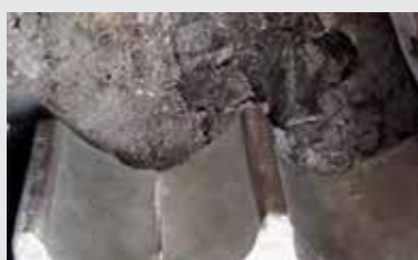
Зубья звездочки. Небольшой износ
