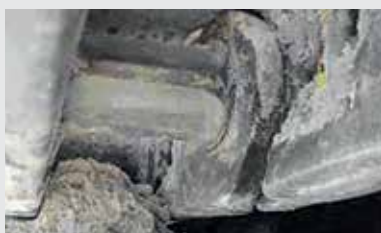
Изношенная втулка (ТРВ при 700ч)
