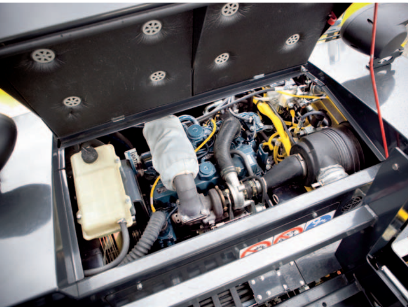
Сильный по мощности, экономичный по расходу: установленный в асфальтоукладчик BF 300 двигатель Kubota.
