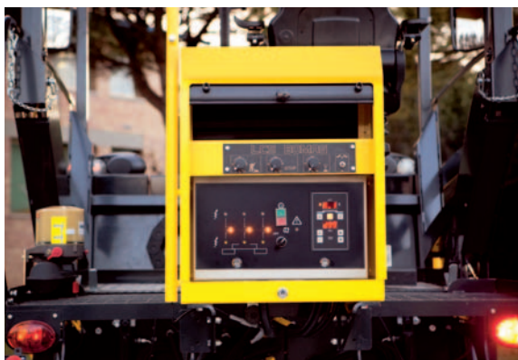
Постоянно на виду: Система разгрузки бруса и регулировка температуры.
