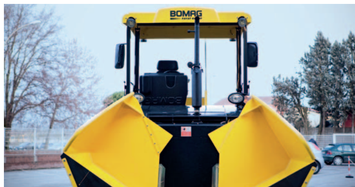
Благодаря системе BOMAG SIDEVIEW при работе на асфальтоукладчике можно обходиться только одним сиденьем и пультом управления.
