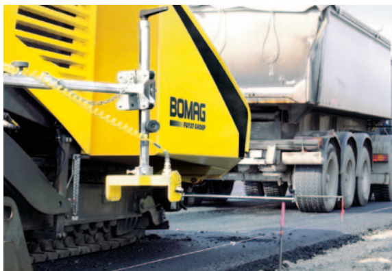
Разносторонность: Интерфейс нивелирования позволяет использовать все распространенные системы и датчики.
