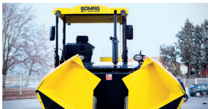
Смена обзорности: Система BOMAG SIDEVIEW для смещения вбок с выступом 40 см.
