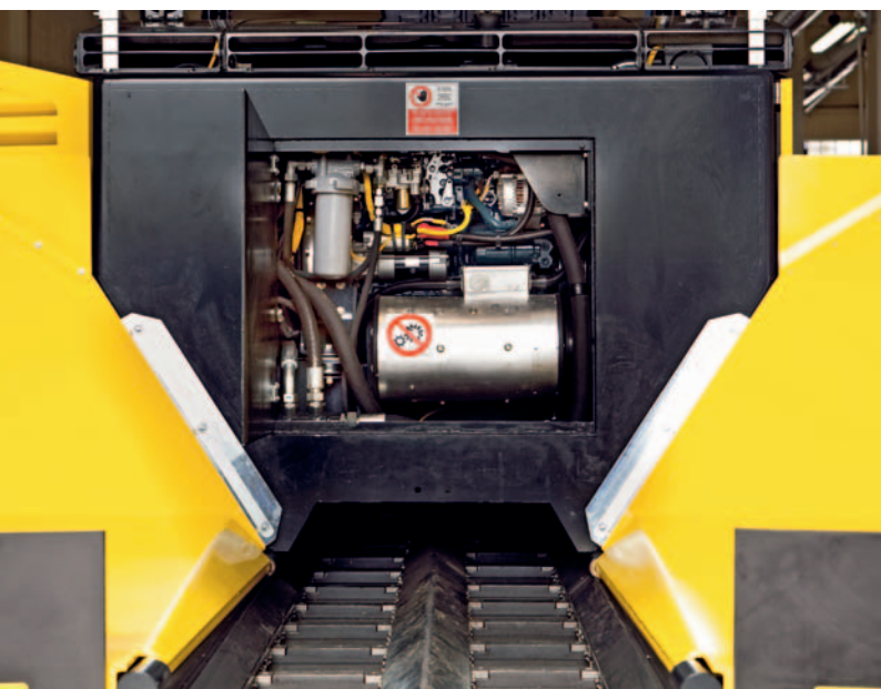
Благодаря мощности в 13 кВт трехфазный генератор переменного тока обеспечивает короткое время нагревания.
