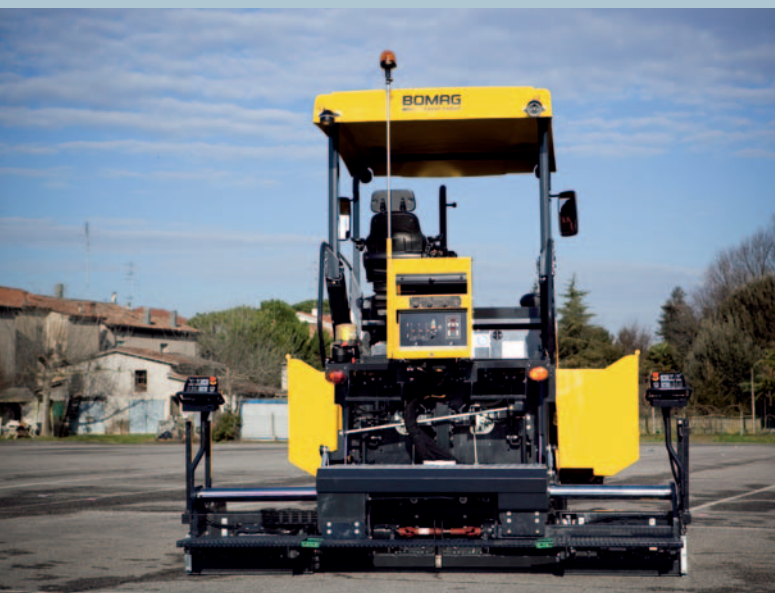
Максимальная ширина укладки базовой плиты: 3,40 метра.
