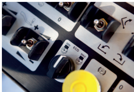
Эффективное технологическое решение: система ECOMODE для пониженного расхода топлива, низкого выброса вредных веществ и излучения шума.
