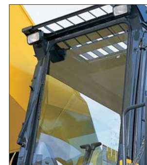
Стеклоочиститель, смонтированный на раме кабины
