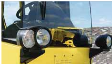
Освещение в соответствии с правилами допуска транспортных средств к движению для безопасной работы на дороге.
