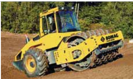
Мощно и универсально в строительстве площадки для хранения отходов и мусора: BW 213 DH с кулачковым вальцом и тракторными шинами.
