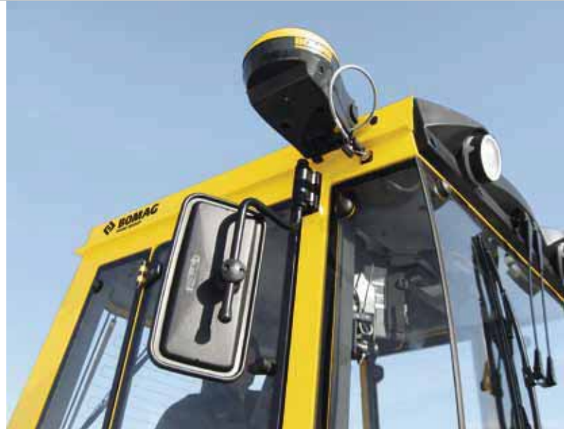
Повсеместное применение: GPS-приемник StarFire фирмы BOMAG.
