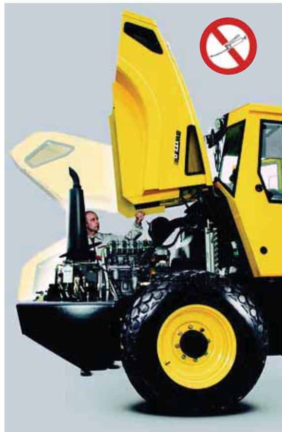
Верное дело: Несколько узлов для проведения технического обслуживания доступны с днища. Капот можно с легкостью открыть вручную.
