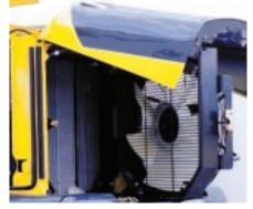
и маслоохладитель расположены в ряд, что повышает эффективность охлаждения и упрощает очистку. Полностью открывающаяся задняя решетка, оснащенная цилиндром газово-пружинного действия, предоставляет оператору удобный доступ к поворотно-откидному вентилятору, радиатору и охладителям.
