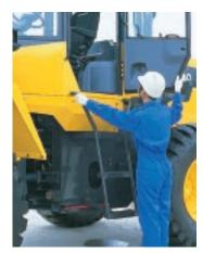
Это облегчает вход и выход, а также устраняет помехи при обзоре во время работы на машине с дверями, зафиксированными в открытом положении. Широкое плоское стекло, не имеющее перегородки, обеспечивает хорошую обзорность. Стеклоочистители охватывают большую площадь, обеспечивая широкий обзор даже в дождливую погоду.
