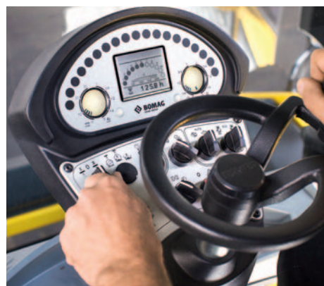
Панель управления всегда находится перед глазами оператора. Управление с помощью выключателей происходит быстро и интуитивно.
