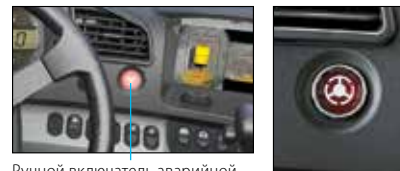
Ручной выключатель аварийной системы рулевого управления
